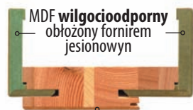
MDF wilgocioodporny obłożony fornirem jesionowym ramiak sosnowy obłożony HDF wilgocioodpornym i fornirem jesionowym
