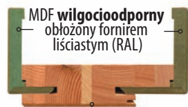
MDF wilgocioodporny obłożony fornirem liściastym (RAL) ramiak sosnowy obłożony HDF wilgocioodpornym i fornirem liściastym (RAL)
