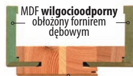
MDF wilgocioodporny obłożony fornirem dębowym ramiak sosnowy obłożony HDF wilgocioodpornym i fornirem dębowym
